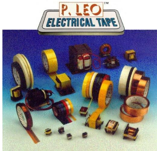
說明 : 1SP10-3 是 0.390mm 厚度的乳白色膠帶，由塗有三層熱固性橡膠壓敏粘合劑的環氧樹脂塗覆 PET 薄膜膠帶組成。常用於包裝繼電器、線圈、變壓器、繞線式次分馬力罩極電機、棒繞或心軸繞線圈和線束。該膠帶通過了 UL 510 阻燃測試。
